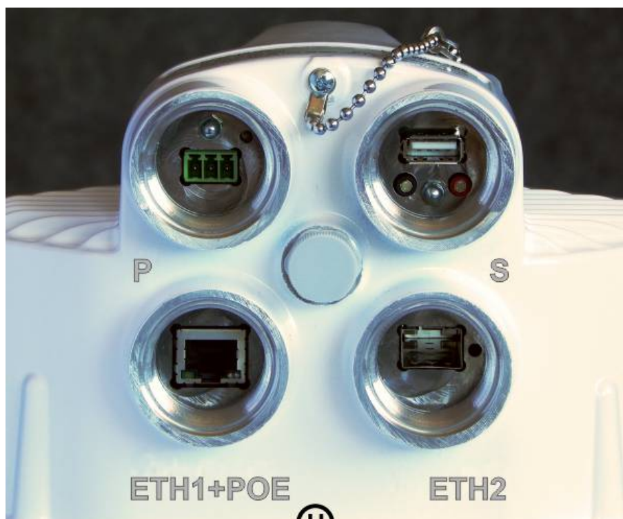
Obr. 4.17: Konektory jednotky RAY
