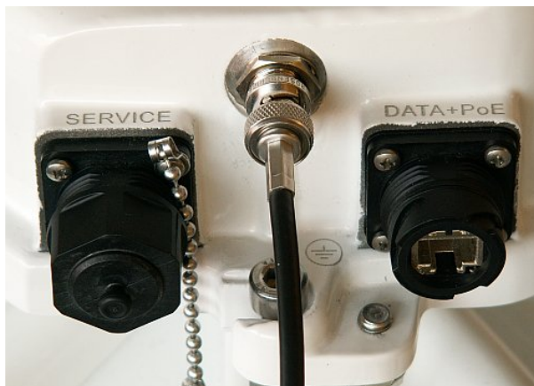
Obr. 5.68: Připojení voltmetru ke konektoru BNC
