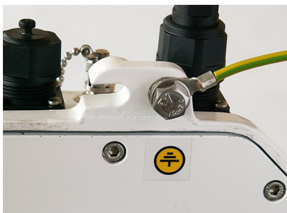
Obr. 5.65: Ochranný vodič jednotky FOD
