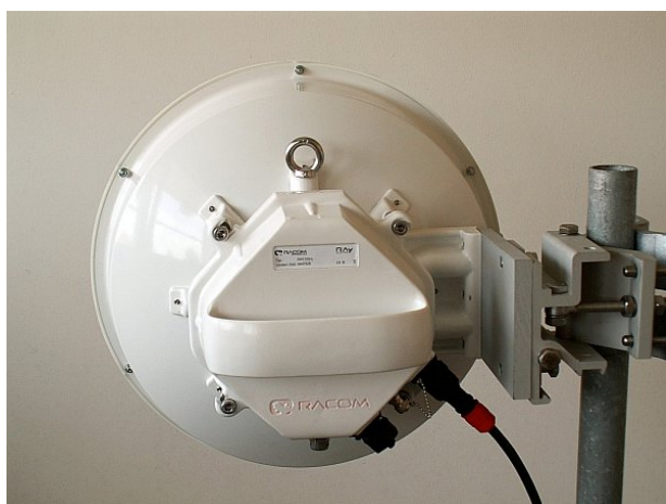
Obr. 5.1: Levá montáž – horizontální polarizace
