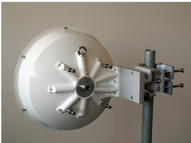
Obr. 5.14: Anténa před montáží jednotky FOD
