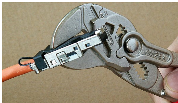
Obr. 5.58: Sevření vnitřního konektoru kleštěmi
