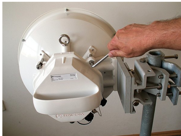
Obr. 5.15: Utažení šroubů na jednotce FOD
