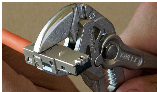
Obr. 5.42: Sevření konektoru do zaklapnutí zámků
