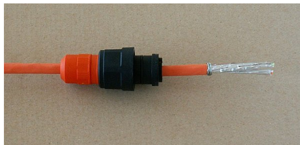
Obr. 5.34: Stínění omotané kolem kabelu
