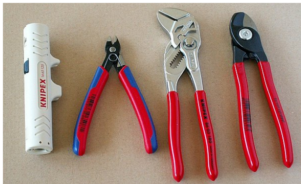
Obr. 5.29: Nářadí pro montáž konektorů
