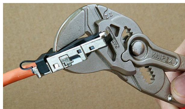
Obr. 5.60: Sevření vnitřního konektoru kleštěmi
