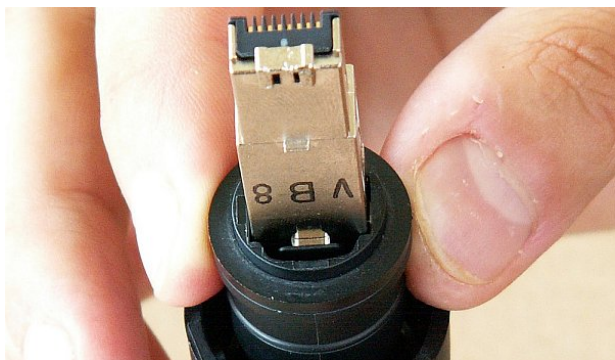
Obr. 5.45: Nasunutí krytu na konektor
