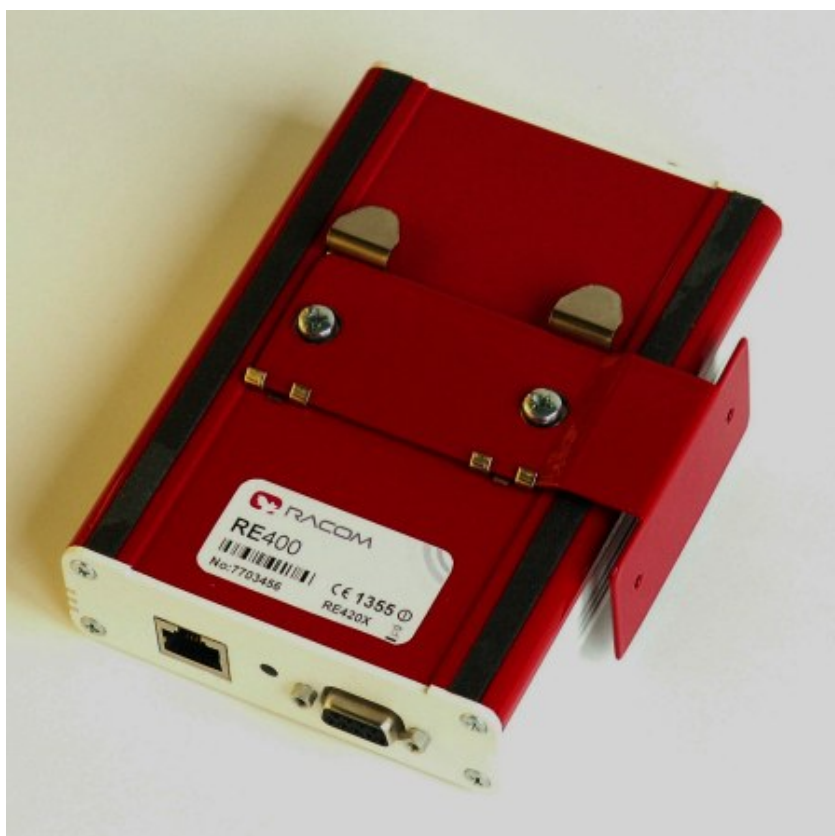
Obr. 6.10: Upevnění modemu pomocí šroubů M3 na výšku, provedení S
