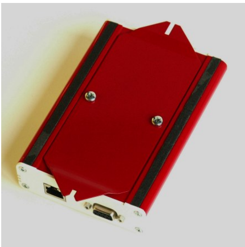
Obr. 6.8: Upevnění modemu pomocí šroubů M3 naplocho, provedení H
