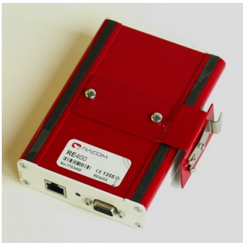
Obr. 6.9: Upevnění modemu na DIN lištu na výšku, provedení R
