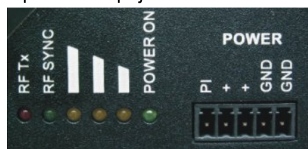
Obr. 3.8: Napájecí konektor a informační LED
