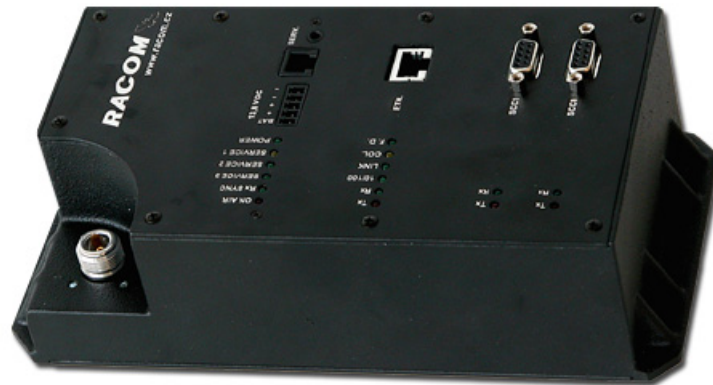
Obr. 1: Rádiový modem MR900 s konektory Cannon a ethernetovým rozhraním
