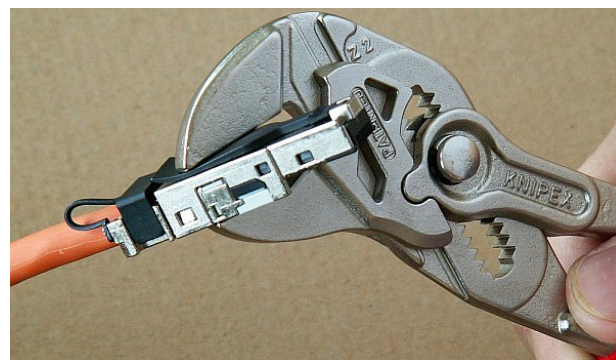
Obr. 5.60: Sevržení vnitřního konektoru kleštěmi
