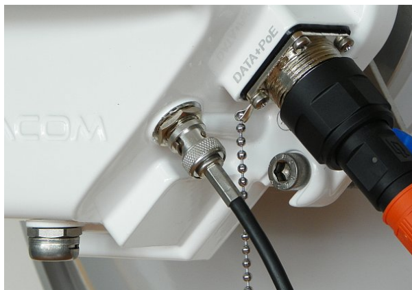
Obr. 5.70: Připojení voltmetru ke konektoru BNC
