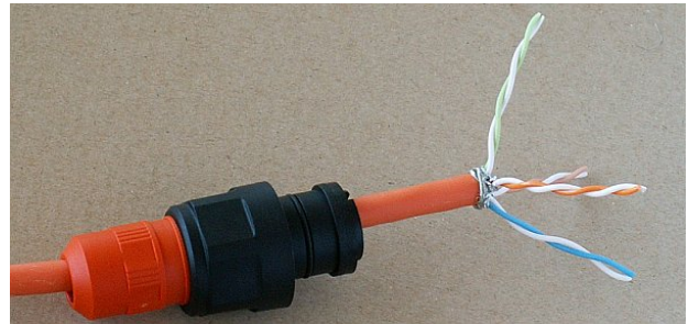
Obr. 5.38: Oddělené páry vodičů
