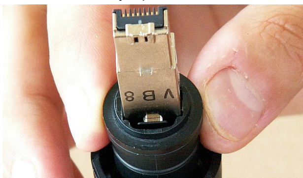
Obr. 5.45: Nasunutí krytu na konektor
