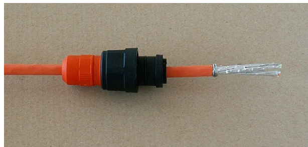
Obr. 5.36: Stínění omotané kolem kabelu
