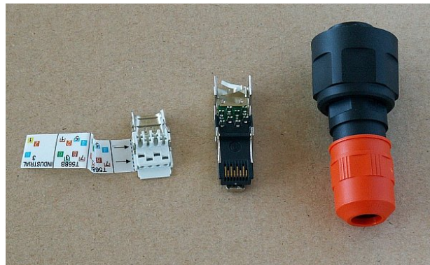
Obr. 5.32: Konektor IE-PI-RJ45-FH před montáží
