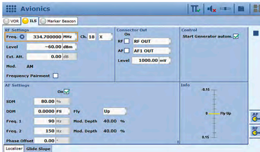
ILS glide slope generator.
